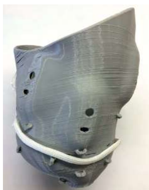
Figura 7. Primer encaje de prueba impreso.
