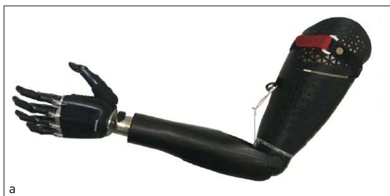
Figuras 10 a-c. Encaje de prueba completo: a) vista general con encaje, articulación del codo y mano protésica; b) en el paciente, vista frontal; c) vista sagital.
